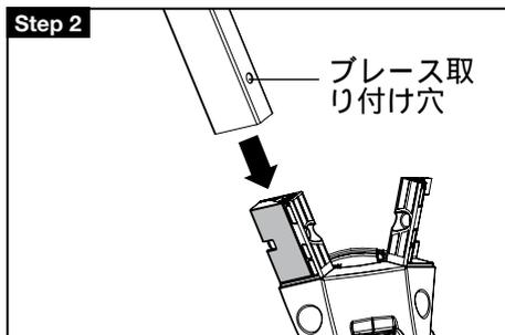
取り付けネジの穴の向きが内側になるよう向きに注意して脚を差し込みます。(このときステップ4の図のようにブレース取り付け穴が内側を向くようにします)
