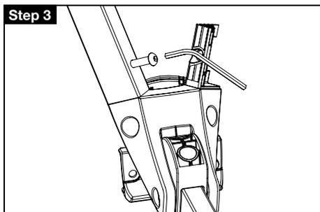
M6 × 30 丸頭スクリューで付属の4 mm 締め付けレンチを用いて脚を確実に締め付けます。
