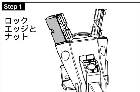
ロックエッジを図のように脚の取り付け部分にセットします。
