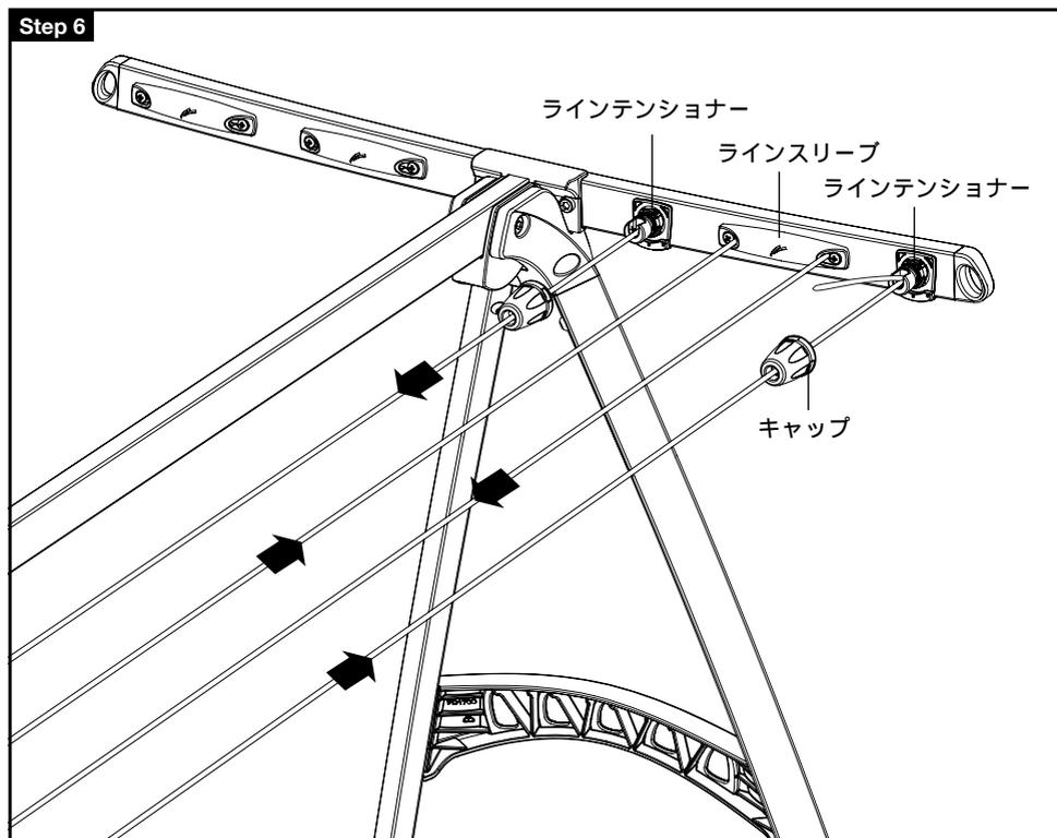
D. カバーキャップを図のように通した後、ラインを外側のラインテンショナーにステップ1～4の要領で取り付けます。仮固定なのでラインは強く引かないでください。
