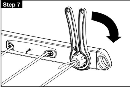
ラインの端をカバーキャップに通し締め付けハンドルを用いて右方向にカチッと止まるまで回します。
