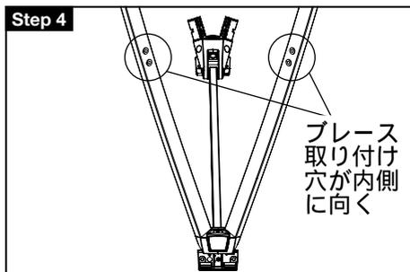
図のようにブレース取り付け穴の向きに注意してください。
